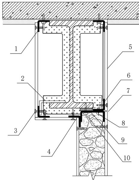
图6 轻集料复合墙内墙构造
