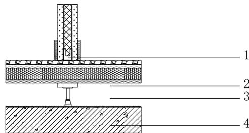
图 8.4.1 装配式楼地面节点示意图
