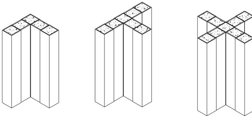
图 5.3.1-1 双板连接型方管混凝土组合异形柱
