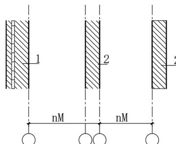
图 4.2.5-2 采用界面定位法的模数基准面
