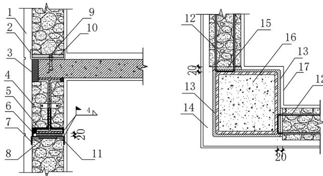
图 4 轻质块体材料填充构造
