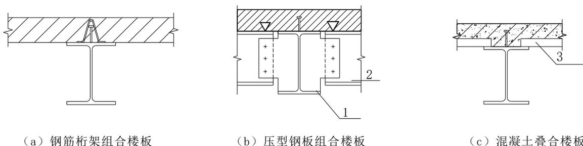
图 5.8.2 装配整体式结构楼盖和屋盖类型
